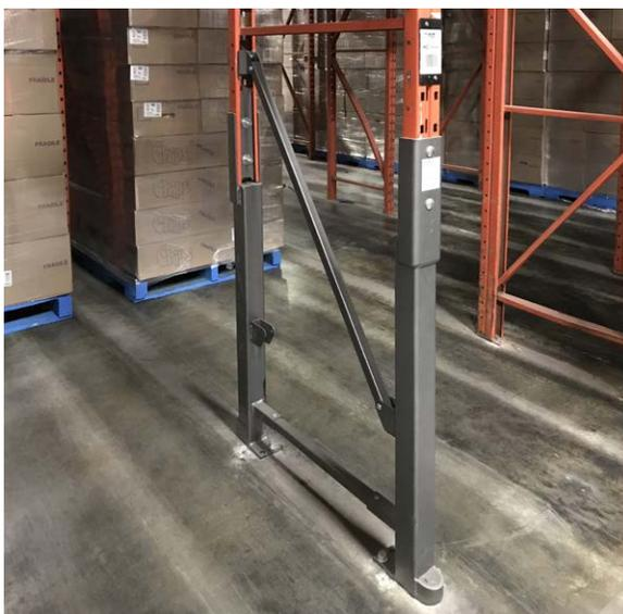
L'unité DAMO FLEX permet aussi de réparer les colonnes avant et arrière d'une échelle.
